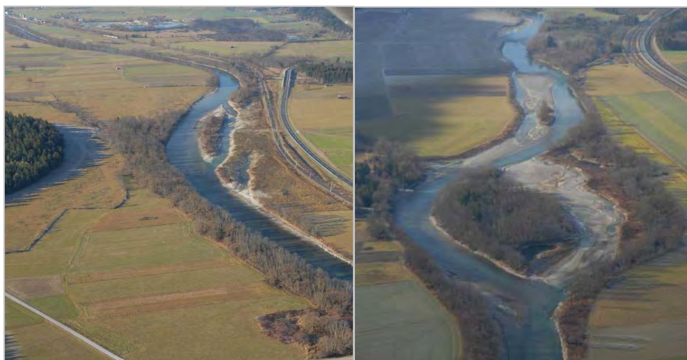
Figur 43 – Restaurering av den effektregulerte elva Drau i Østerrike gir refuger og forsinker forplantning av vannføringsendringer etter restaurering (til høyre) sammenliknet med den mer kanaliserte elva til venstre. ( http://www.life-drau.at )
